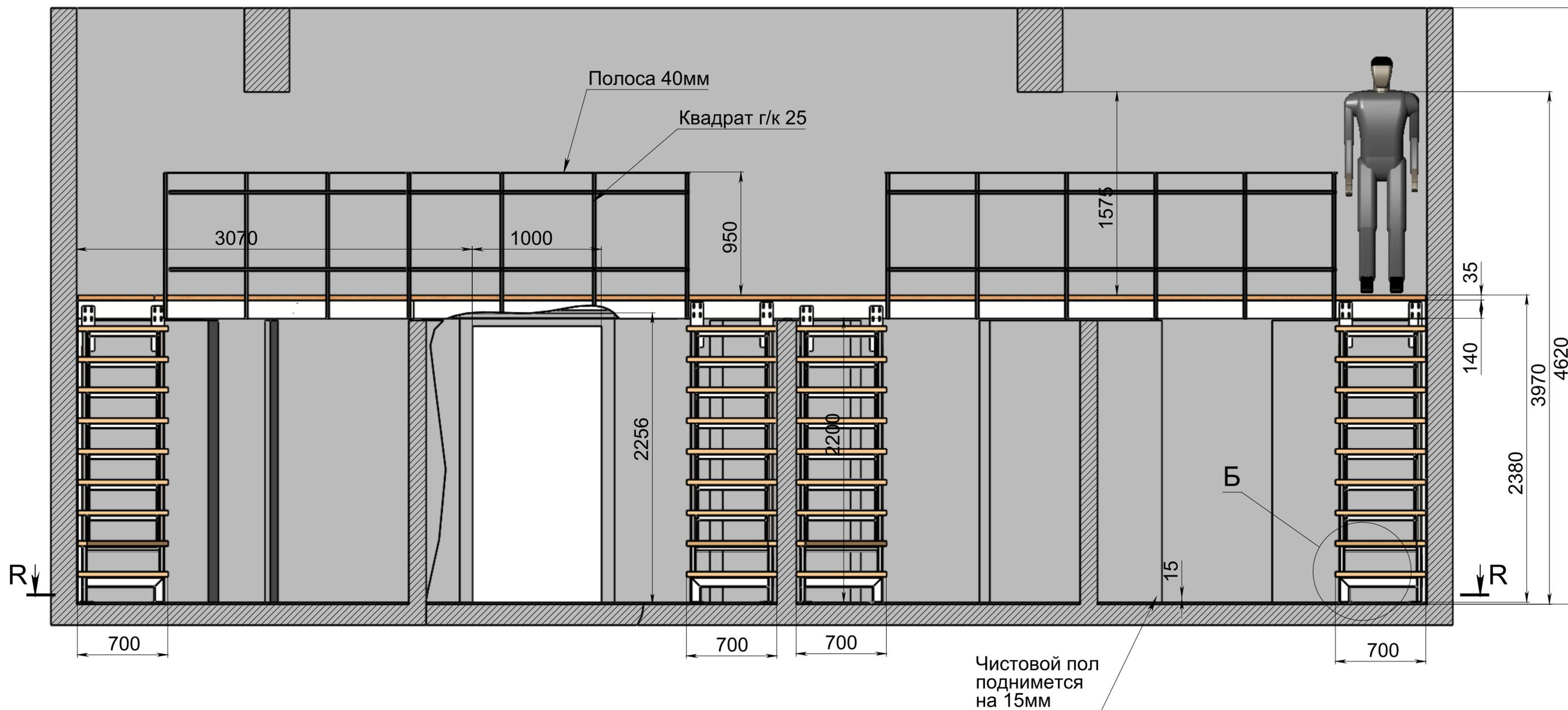
Металлический каркас лестницы изготавливается из профильной трубы 80x40x2мм. Основание антресоли из швеллера 140 перемычки из профильной труба 80x40x2мм
